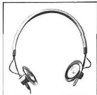
Dynamischer Zwillingshörer W 671 HIFI-Kopfhörer für Mono und Stereo. Frequenzbereich 20–20 000 Hz. Max. unverzerrter akustischer Dauerpegel 127 Phon pro System bei einem Klirrfaktor \leq 3\% im gesamten Übertragungsbereich.
