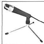
Dynamisches Stab-Richtmikrofon M 534 Tischmikrofon mit nierenförmiger Charakteristik. Sprach- und Musikumschalter. Frequenzbereich: 50–18 000 Hz. Als Paar für Stereo-Aufnahmen geeignet; hierzu Stereoschiene M 925 lieferbar. Für UNIVERSAL 5000 Reduzierstück K 836 verwenden.
